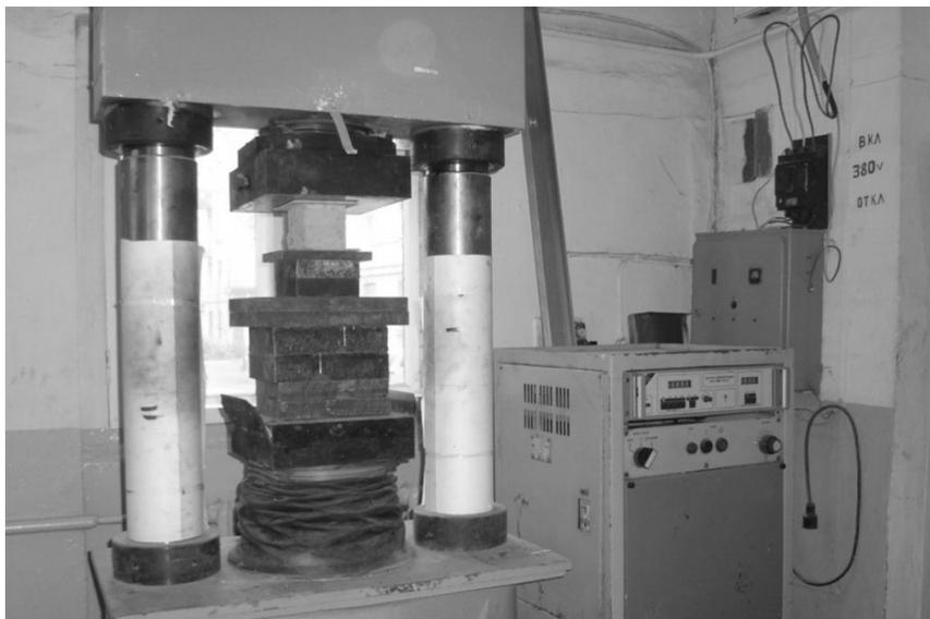
*в) Установка образца на пресс, совмещение центров*
