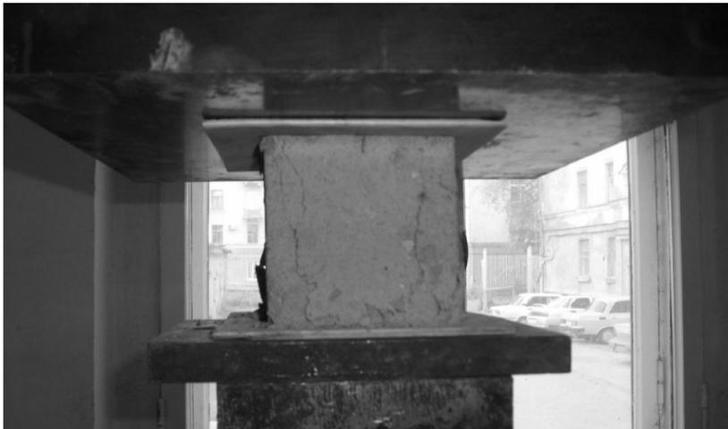
*в) Начало деформации образца с увеличением нагрузки*
