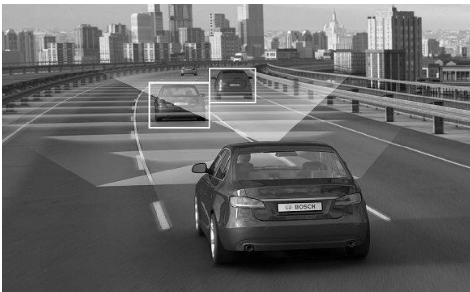
Рис. 2. Система распознавания объектов Bosch
