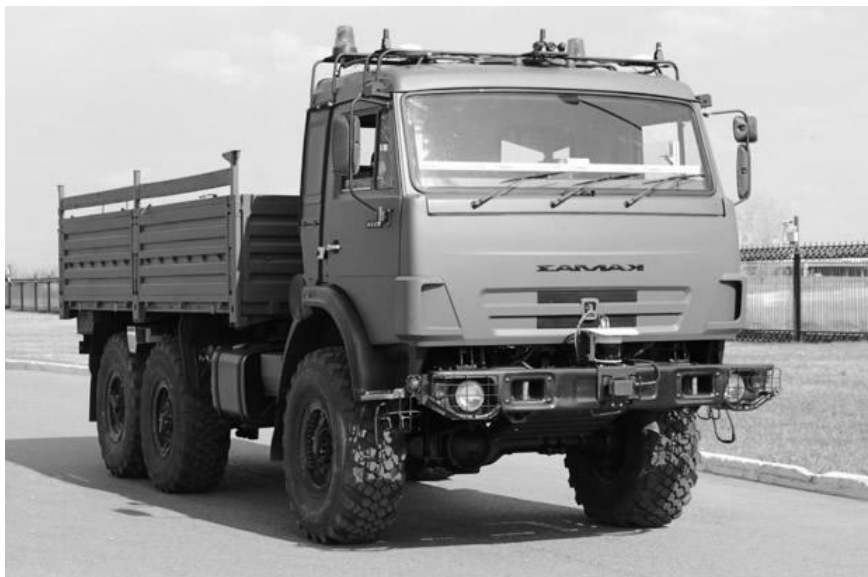
Рис. 1. Прототип беспилотного КАМАЗа
