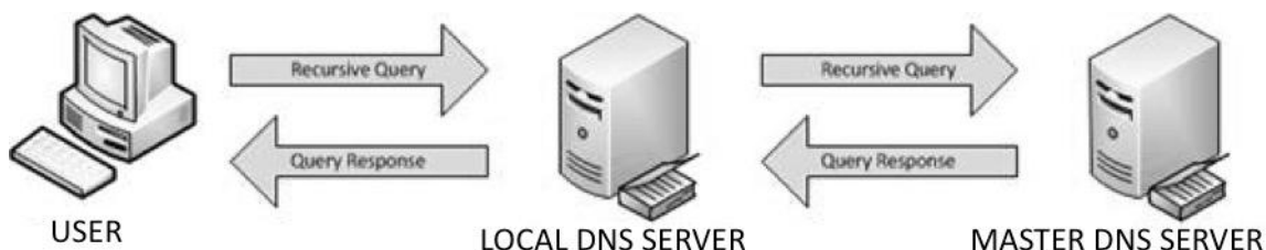
Рис. 2. DNS запрос и ответ с помощью рекурсии
