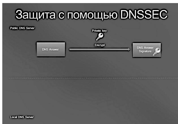
Рис. 13. Цифровая подпись каждой записи
