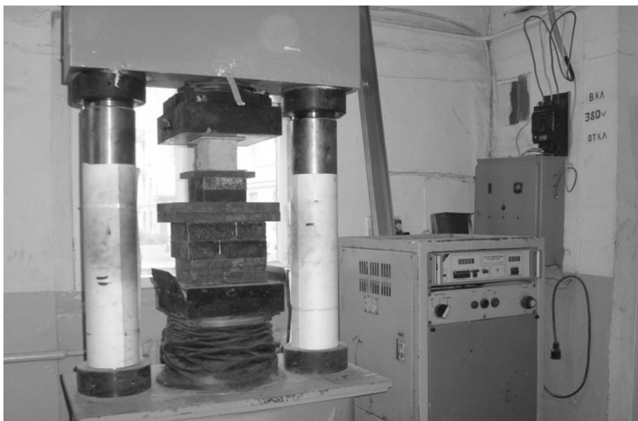
Г) Начало деформации образца с увеличением нагрузки
