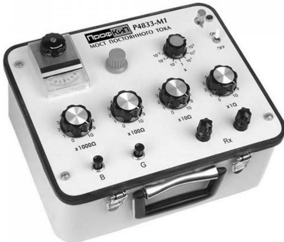
Рис. 3. Прибор для определения зоны повреждения кабеля петлевым методом – P4833-M1 мост постоянного тока (прибор универсальный измерительный)
