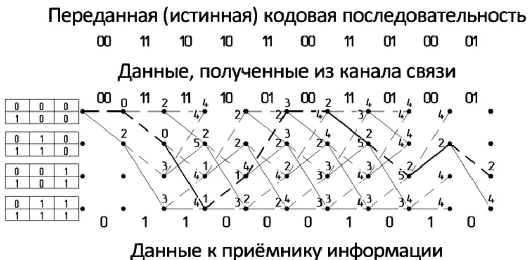
Рис. 4. Треллис-диаграмма сверточного декодера
