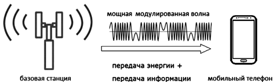
Рис. 1. Система беспроводной передачи информации и передачи мощности
