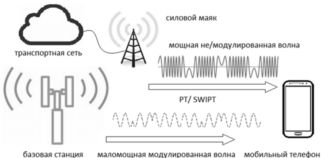
Рис. 2. Система беспроводной передачи информации и передачи мощности с поддержкой силового маяка
