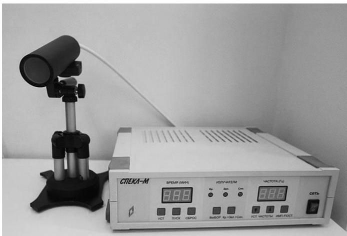
Рис. 1. Аппарат лазерной терапии «Спекл-М»
