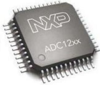
Рис. 2. Пример аналого-цифрового преобразователя(АЦП)
