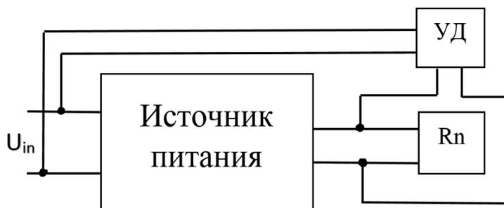
Рис. 1. Структура диагностики. УД – устройство диагностики
