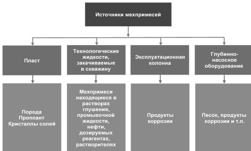
Рис. 1. Источники возникновения механических примесей в скважине
