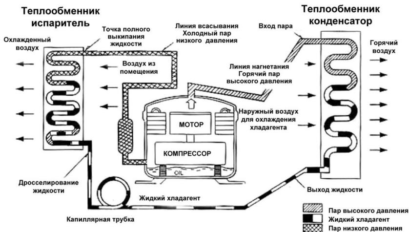
Рис. 1. Схема кондиционера
