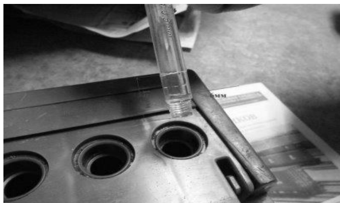
Рис. 3. Проверка уровня электролита
