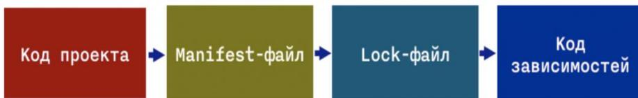
Рис. 2. Типовая схема проекта при использовании СУП с указанием последовательности исполнения алгоритма
