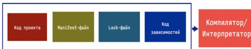
Рис. 3. Типовая схема проекта при использовании СУП с указанием шага компиляции или интерпретации
