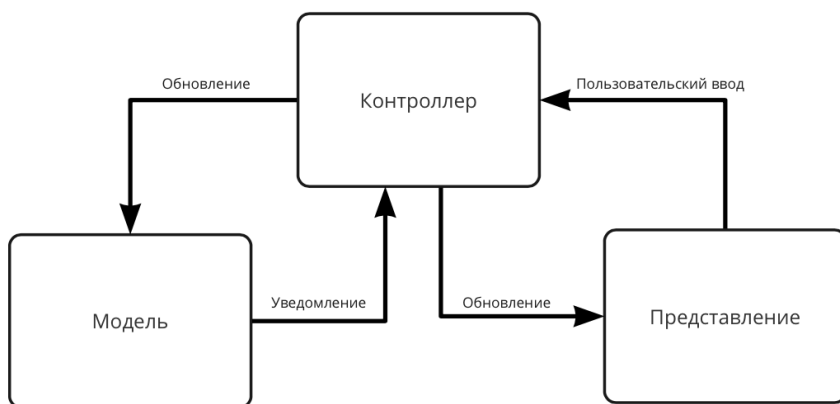
Рис. 3. Схема работы шаблона модель представление контроллер, реализованная компанией Apple
