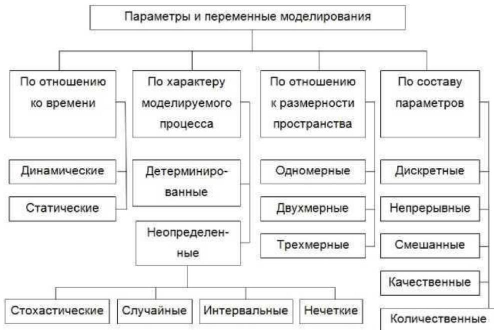
Рис. 3. Классификация математических моделей в зависимости от входных и выходных параметров
